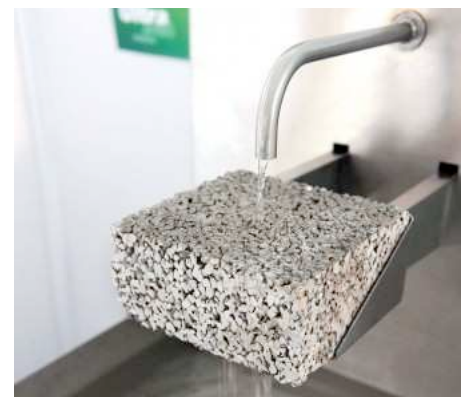
Figure 38 : béton drainant (Lafarge 2011)
