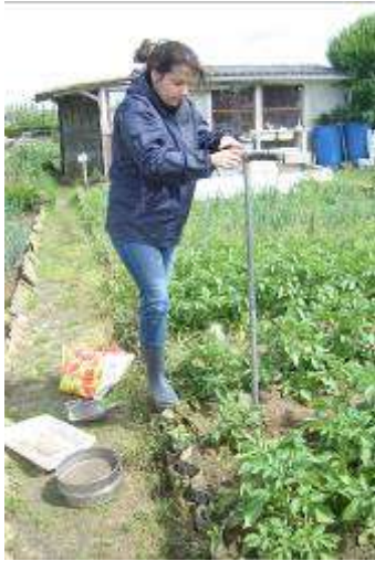
a) Carottage à la tarière
