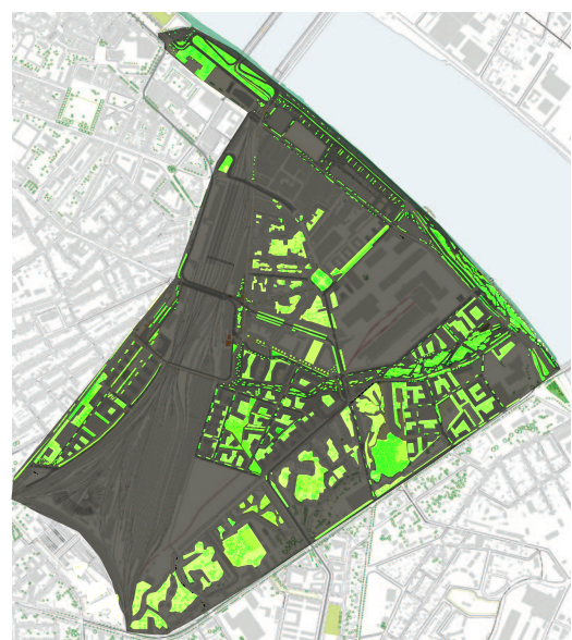
Figure 38 : Plan de perméabilité état projet (LEJAMTEL, 2012)
