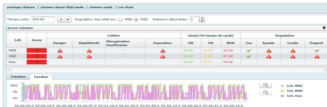
Figure 0-11 : cotation du risque TMS : portage de chaises (3'22), flexions dos et gestes répétés
