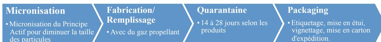
Figure 31. Représentation schématique du processus de fabrication
