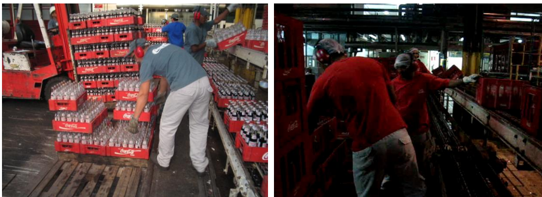
Figure 14 : Dépalettisation de caisses basses à gauche et hautes à droite.
