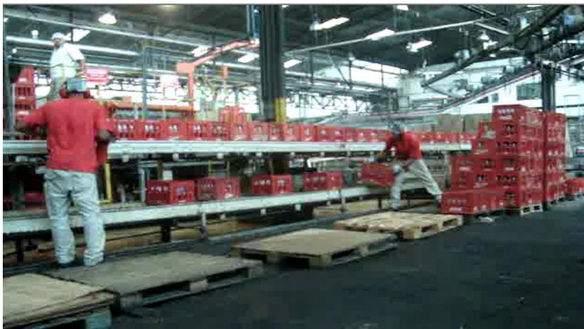
Figure 17 : Assistants de la dépalettisation utilisant également le tapis inférieur.
