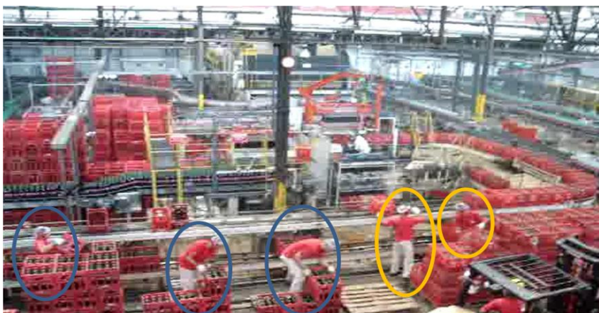
Figure 11 : Présence de trois assistants dans la Palettisation au lieu de deux comme normalement.
