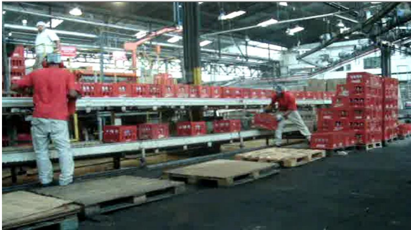
Figure 17 : Assistants de la dépalettisation utilisant également le tapis inférieur.
