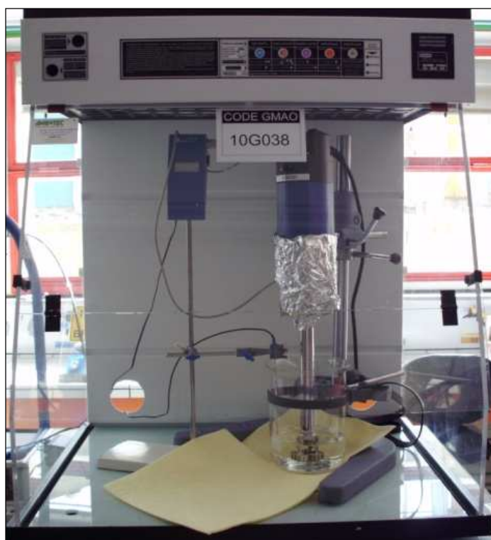
Figure 16 : Installation du poste de travail pour les lots de 2 000 g.
