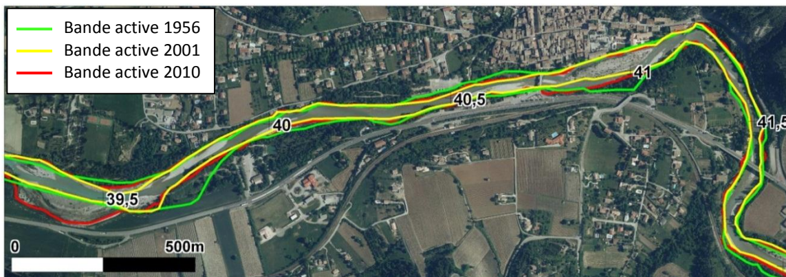
Fig.13. Emprises des bandes actives en 1956, 2001 et 2010 au niveau de la traversée de la commune de Saillans.
