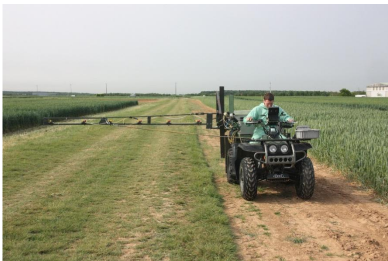
Figure 32: Quad équipé d'un pulvérisateur à air comprimé
