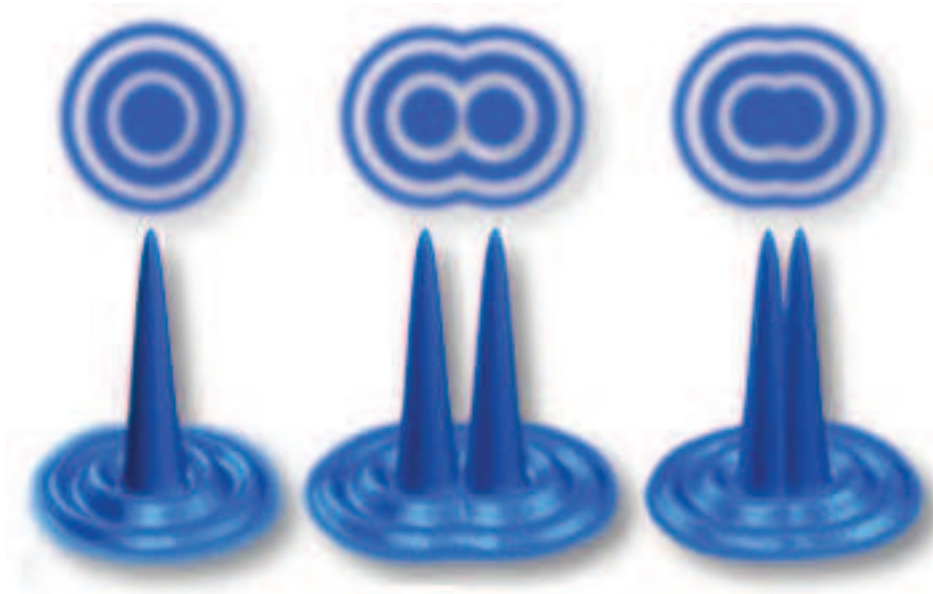
Figure 22: représentation des FEP en fonction de la distance entre 2 points objets. Pour que 2 points soient perçus distinctement ils nécessitent d'être suffisamment éloignés (image du milieu), dans le cas contraire les images se superposent (image de droite). Illustration : Naturoptic.
