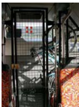
Photo 3 : Equipement d'un car du conseil général de Savoie permettant le transport de vélos
