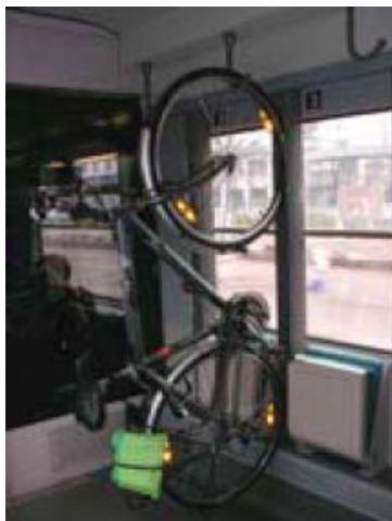
Photo 2 : Système de porte-vélo avec crochets sur rails dans certains TER
