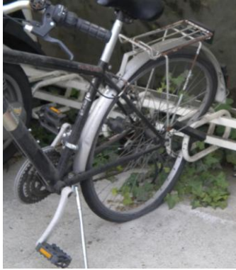
Figure 27 : Roue voilée par le stationnement en pince-roue, Gare de Chaville RD, source : Lise CHESNAIS
