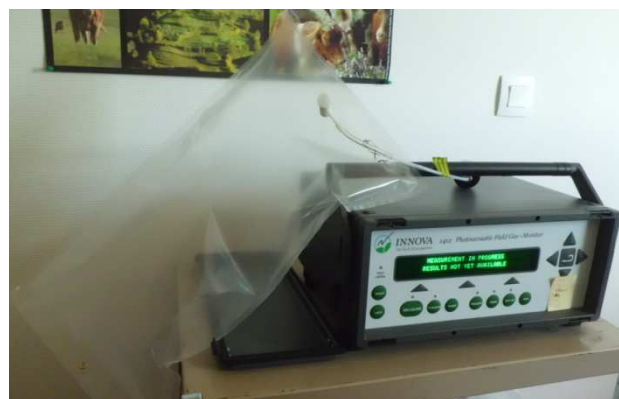
Figure 16 : Sac TEDLAR® branché sur l'entrée d'air de l'analyseur de gaz INNOVA 1412®
