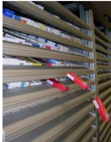
Libération des produits par abaissement de la butée
