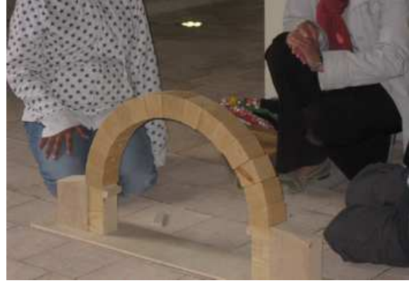
Construction d'un arc plein cintre
