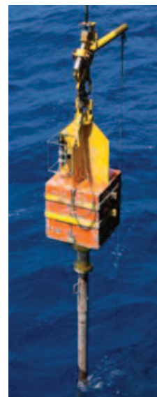
Figure 6 : Mise à l'eau du carottier Calypso (Source : Centre de Carottage et de Forage National)
