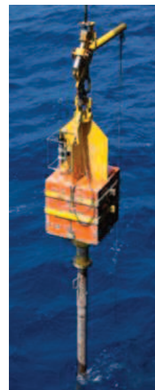
Figure 6 : Mise à l'eau du carottier Calypso (Source : Centre de Carottage et de Forage National)
