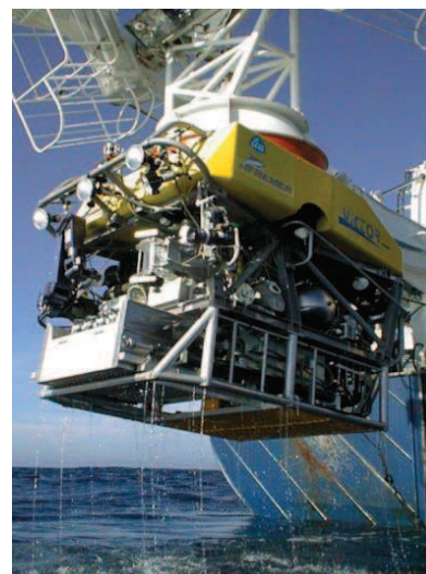
Figure 5 : Mise à l'eau du robot télé-opéré Victor 6000 (Source : IFREMER)
