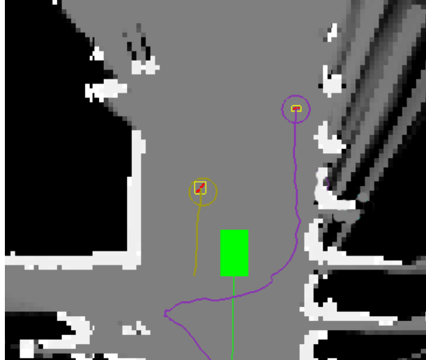
FIGURE 2.4 – Illustration de la grille d’occupation. Les objets statiques sont blancs et les dynamiques représentés en couleur par leurs cercles associés. Le système autonome au centre est en vert. (Extrait de l’article [10])
