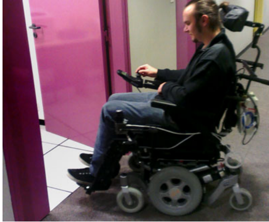
FIGURE 1.1 – Fauteuil roulant utilisé dans le projet Apash. Nous pouvons distinguer la caméra sur l’avant gauche du fauteuil, ainsi que le boîtier permettant de contrôler le fauteuil par Wifi à l’arrière.
