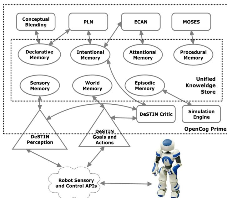
FIGURE 4 – Diagramme haut niveau de l'architecture CogBot.
