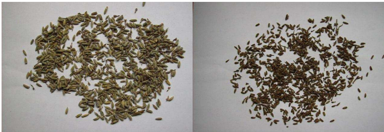
Figure 39 : Matière première brute et matière première traitée. (La matière, suite au traitement, a perdu sa couleur. Une fois distillée, les glandes sécrétrices vidées de leur huile essentielle, s'affaissent.) [17]
