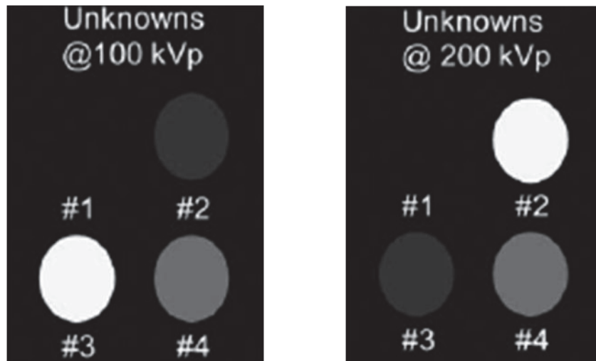
Figure 7 : Principe de la différenciation entre les structures par le scanner double énergie 31 .
