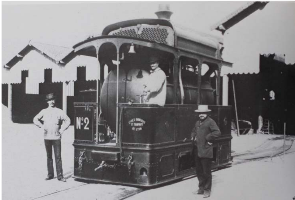
Illustration 41: Locomotive sans foyer utilisée par l'OTL
