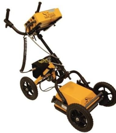
Figure 4 : Exemple d'un Géoradar : le Seeker SPR
