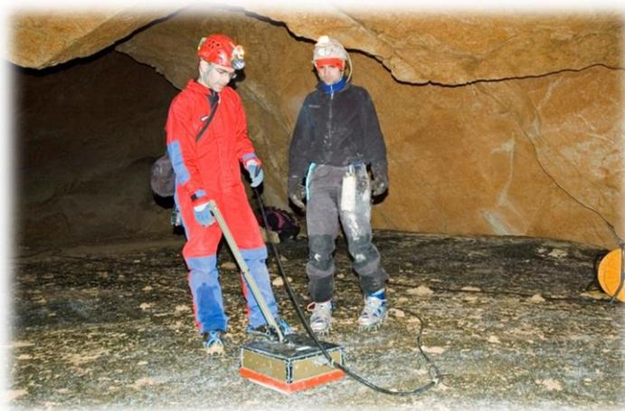
Figure 7 : Application du géoradar pour une fouille archéologique
