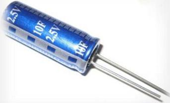
**Le condensateur** : c'est un composant électronique capable de stocker de l'énergie, sous la forme d'un champ électrostatique. Il s'agit d'un composant dit passif, qui est constitué de deux surfaces conductrices d'électricité que l'on appelle armatures, mises face à face et séparées par un isolant, le diélectrique. La relation caractéristique d'un condensateur idéal est :
