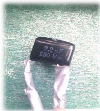
Figure 27 : Photographie du condensateur soudé au câble lors du test de précision
