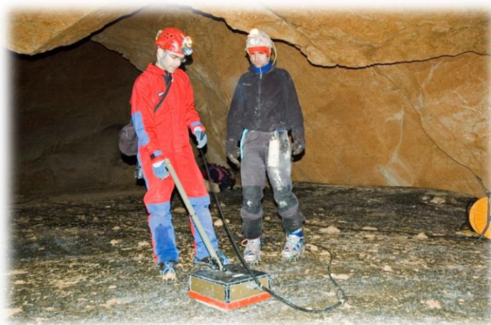
Figure 7 : Application du géoradar pour une fouille archéologique
