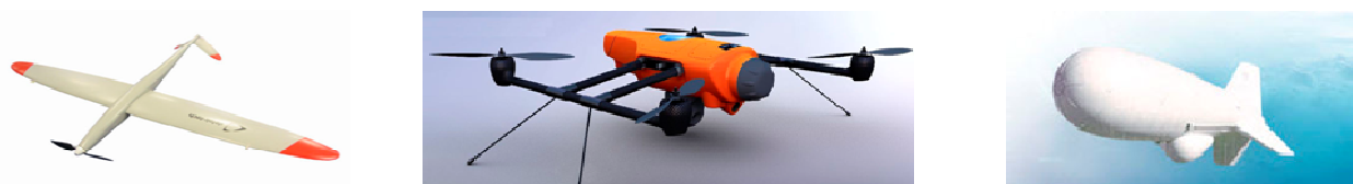
Figure 1 - De gauche à droite : voilure fixe (Source Delair Tech), voilures tournantes (Source : Delta Drone) et ballon (Source : Foonsung)
