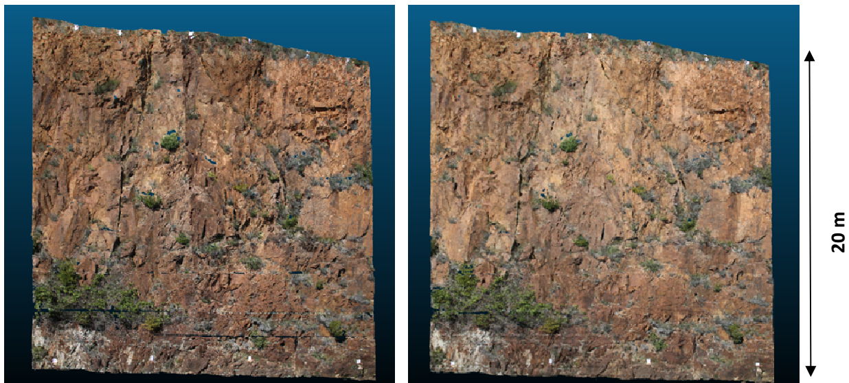
Illustration 3.10 - Nuage de points par photogrammétrie terrestre. À gauche : Terre + canne ; À droite : Terre
