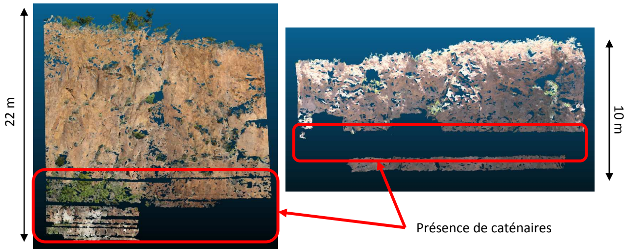
Illustration 3.17 - Nuages de points issus du drone : à gauche paroi V1 ; à droite paroi V2
