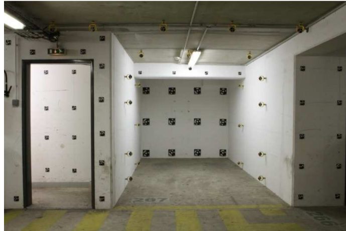
Illustration A10.1 - Mur d'étalonnage SNCF
