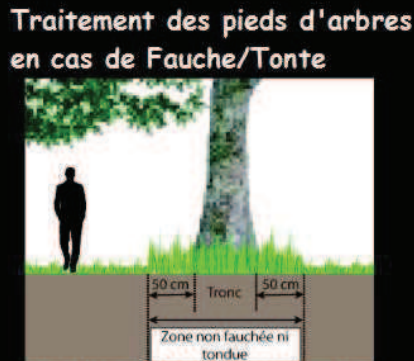
Lors des actions de fauche ou de tonte, on laisse une zone non fauchée de 50 cm autour des pieds d'arbre, afin d'éviter toute blessure potentielle à l'arbre, notamment aux platanes.
