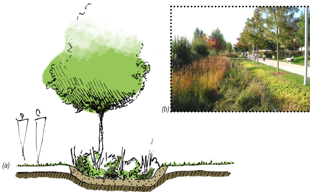
Figure 15 : (a) Coupe de principe d'une noue (b) photo référence d'une noue au parc Batignolles, Paris, octobre 2010. (source : E. Boutot)
