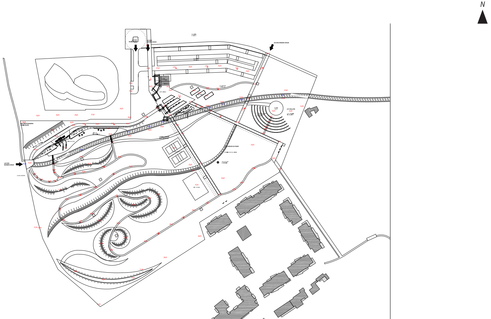
ANNEXE VIII : Plan du principe de nivellement du projet du Domaine de La Tour (échelle : 750e) (source : E.Boutot)
