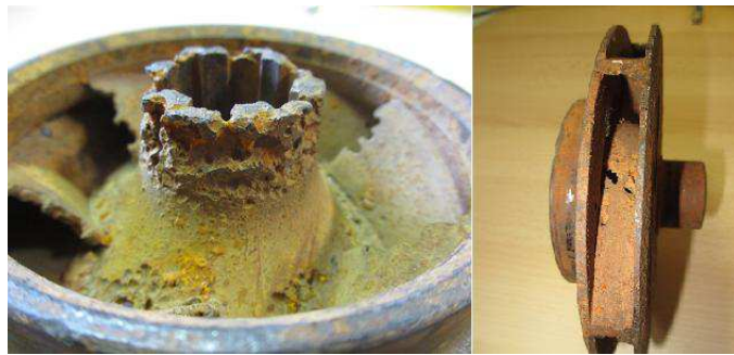
Figure 15 : conséquence de la cavitation sur une turbine (UASA, 19/08/2013, V. Frizon de Lamotte)
