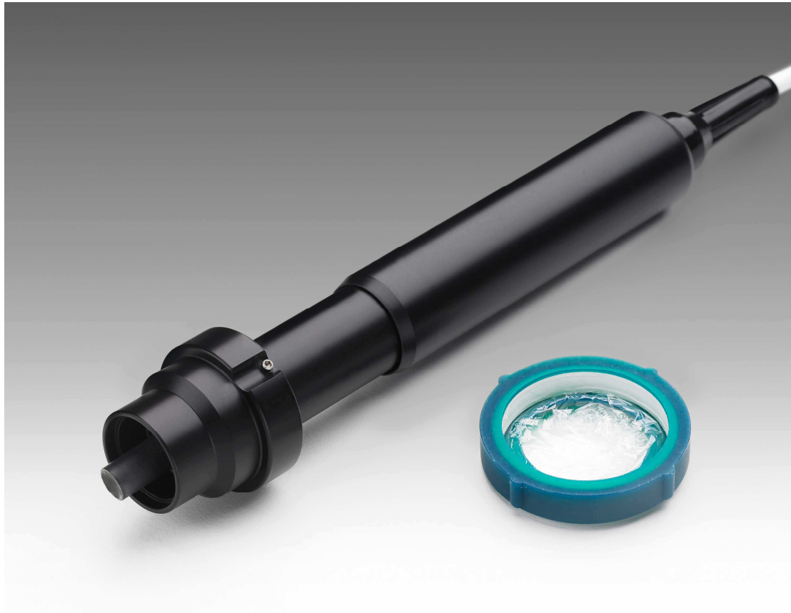
Figure 3 - Sonde échographique de 10 - 40 MHz. Modèle UBM Ellex
