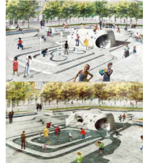
Figure 11 : Images de synthèse simulant le remplissage du Wondrous Water Square, Rotterdam, Pays-Bas, crédits : De Urbanisten Le square dissimule un bassin tampon pour les eaux de pluies et d'orages.
