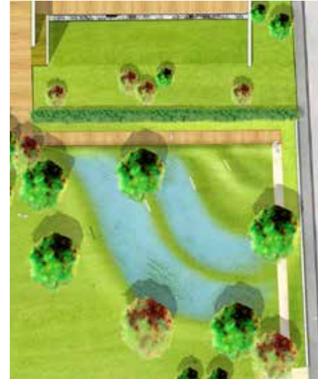
Figure 10 : plan du square Jean Mermoz, Villemonble, crédits : Composante Urbaine Le square recueille les eaux de ruissellement du quartier
