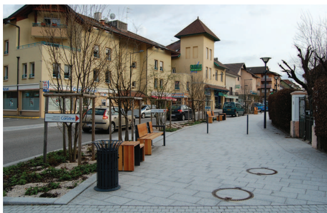
Fig. 25 : photographie - De larges trottoirs sont séparés de la chaussée par une bande de plantations - Cruseilles. Source : Atelier UO, 2013.
