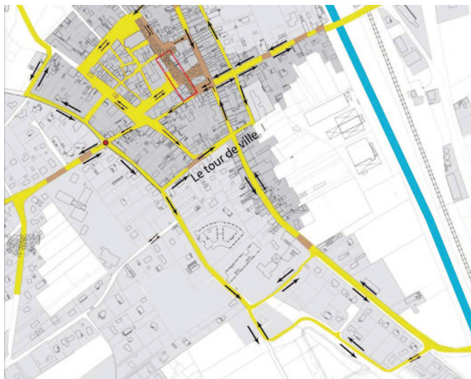
Fig. 20 : plan de circulation - Grisolles. Réorganisation de la circulation par des sens uniques. Source : D'une ville à l'autre , 2006.
