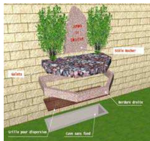
Figure 43 : schéma d'un puits de dispersion (photo : Dignité Funéraire, www.dignite.fr)
