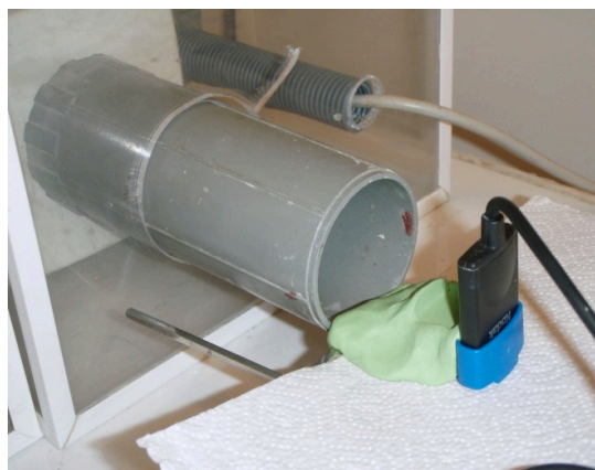
Figure 8 a,b,c : Montage des dents en vue de la réalisation de clichés radiographiques superposables
