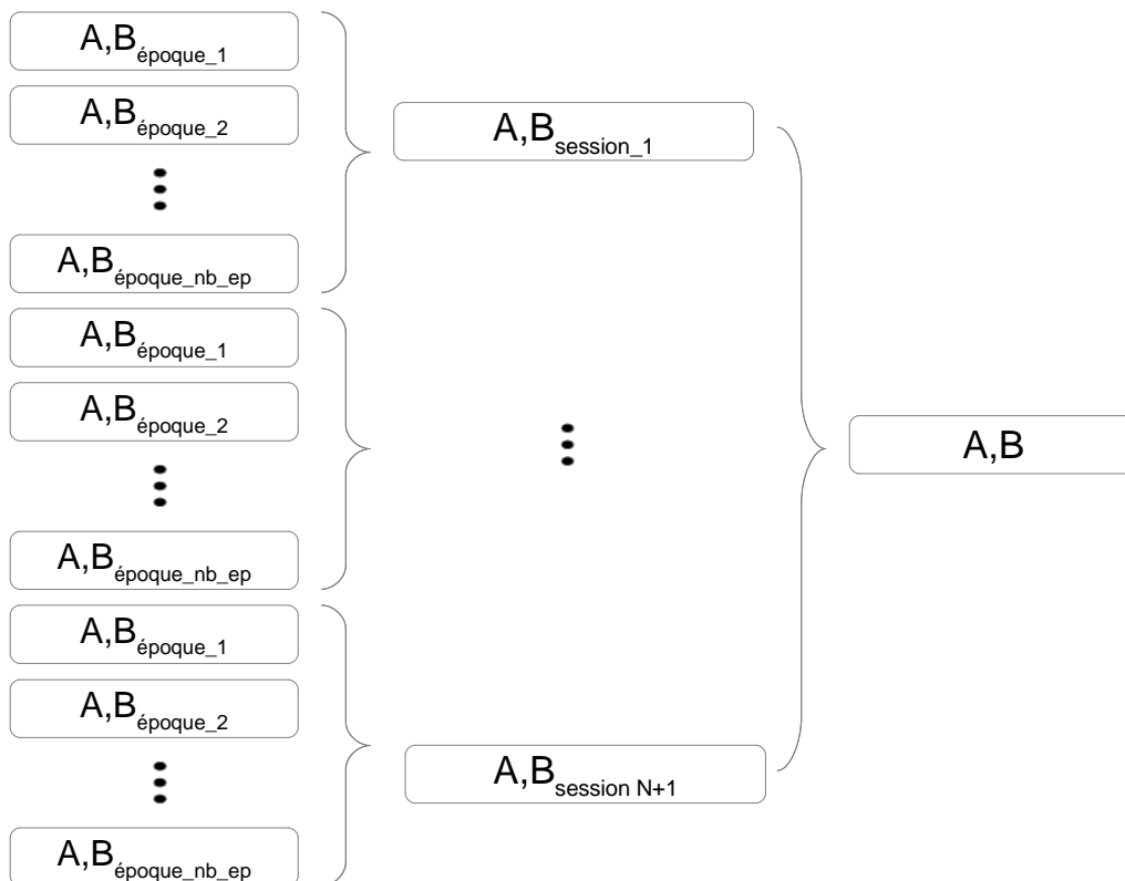
Figure 20 :Schéma de concaténation des vecteurs A et scalaires B issues des époques des N+1 sessions d'observation avec N, le nombre d'interférogrammes utilisés dans le traitement STUN. À la suite de leur concaténation, nous obtenons une matrice A et un vecteur B.
