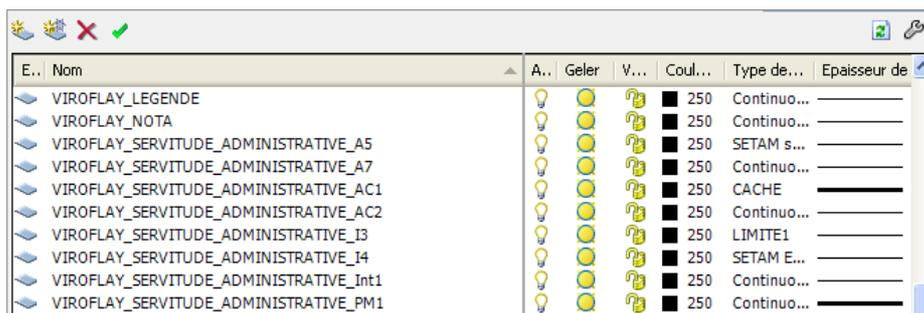
Illustration 14 : Gestionnaire des calques sous le logiciel AutoCAD
