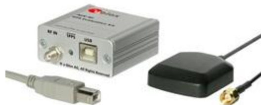
Figure 3.1 : Récepteur et antenne ublox utilisés
