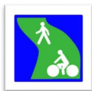
Figure 6: C115 : Voie verte – voie réservée à la circulation des piétons et des véhicules non motorisés ©Wikimedia
