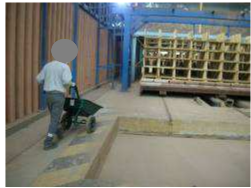
Figure 4 : Transport du sable vers l'entrée des fours
