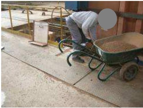
*Figure 3 : Récupération du sable dans la goulotte de sortie*
