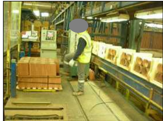
Fig. 13.B : opération de resserrage sur le 2° étage de la palette
