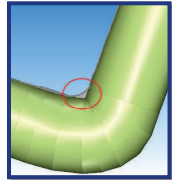
Figure.42 : Erreur du modèle coudé
