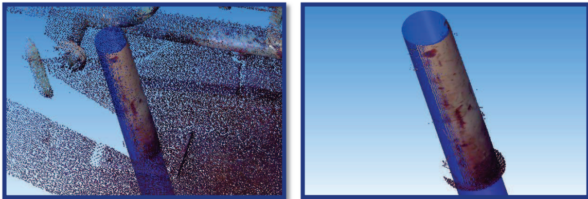
Figure.14 : Segmentation par un modèle CAO
