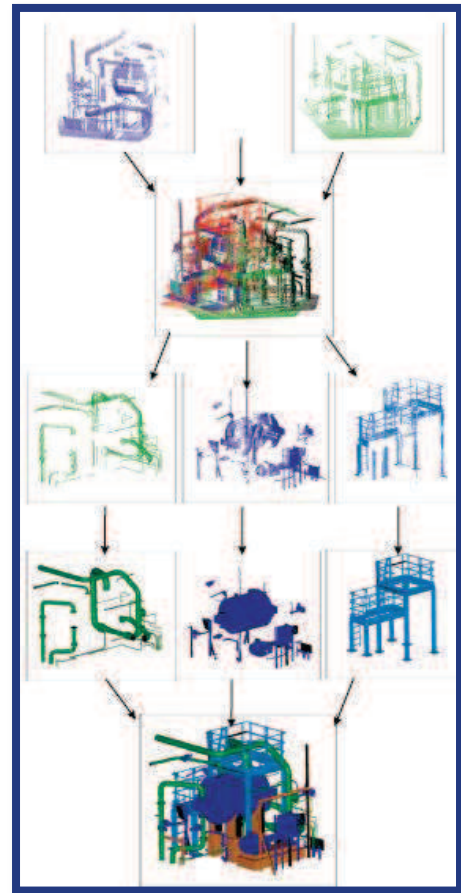
Figure.12 : Phases de traitement de la modélisation
