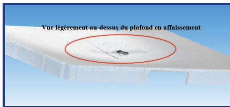
**Figure.28** : Exemple d'un plafond en affaissement
