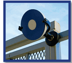
Figure.5 : Cible circulaire à deux disques
