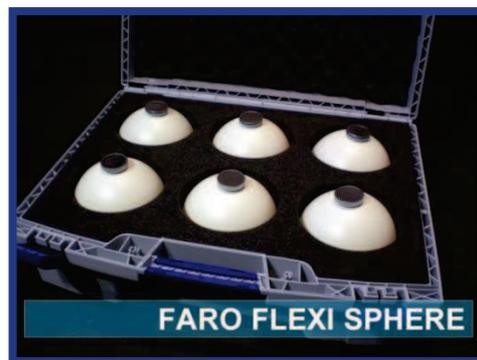
(**Figure.4** : cibles sphériques, <http://shop.laserscanning-europe.com>)
