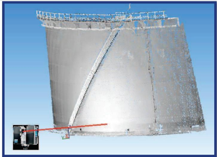
**Figure.35 :** Exemple d'un choix judicieux d'extraction de cylindre sur un nuage
