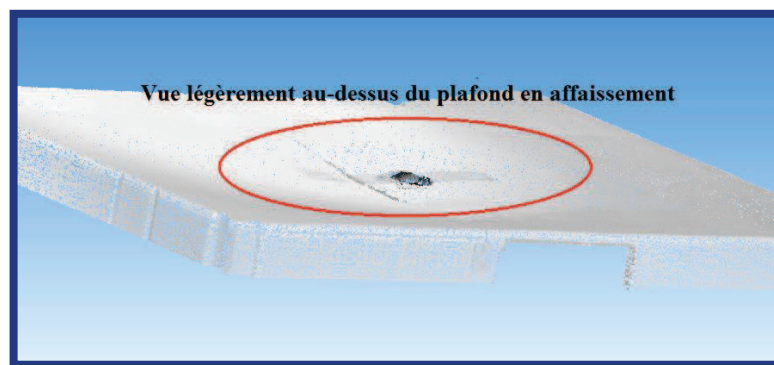
Figure.28 : Exemple d'un plafond en affaissement
