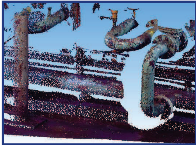
Figure.8 : Nuage de points « Tuyau » sur 3DReshaper
