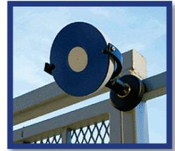
**Figure.5** : Cible circulaire à deux disques
