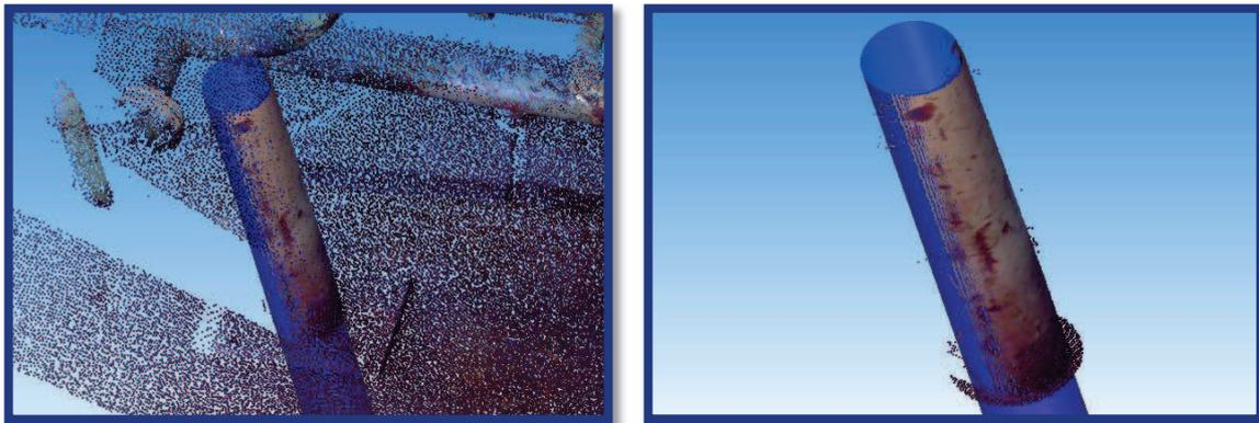
**Figure.14** : Segmentation par un modèle CAO
