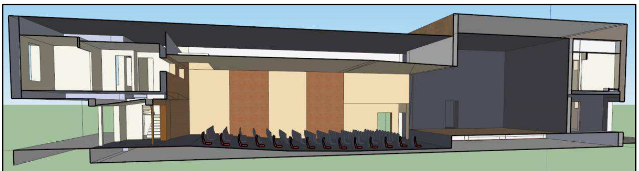
Vue en coupe de la modélisation 3D de l'auditorium produite sous SketchUp
