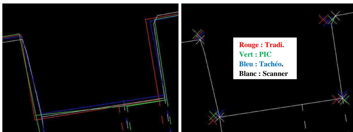
Figure 20 : Comparaison de la précision des méthodes : à gauche superposition des reports graphique, à droite visualisation de quelques points choisis pour la comparaison CloudCompare
