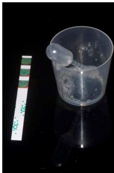
Figure 23. Mesure de la capacité tampon. (Document C.Bonafos)
