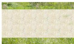
Un revêtement en stabilisé calcaire compacté est mis en place sur l'ensemble du cheminement principal. D'une largeur de 1,80m, ce cheminement permet à deux fauteuils de se croiser, ce qui constitue une largeur confortable pour l'ensemble des usagers.
