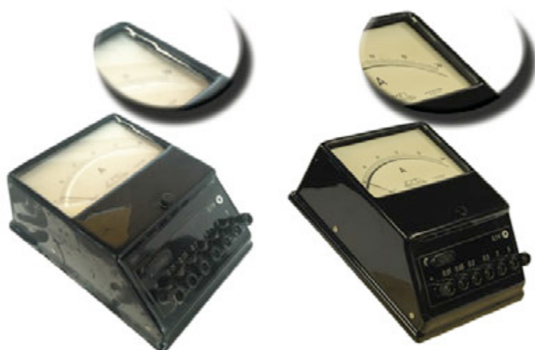
Fig. 2 Comparatif ampèremètre - Cimel - 6311/42 avant et après restauration, © Thomas Névo.
