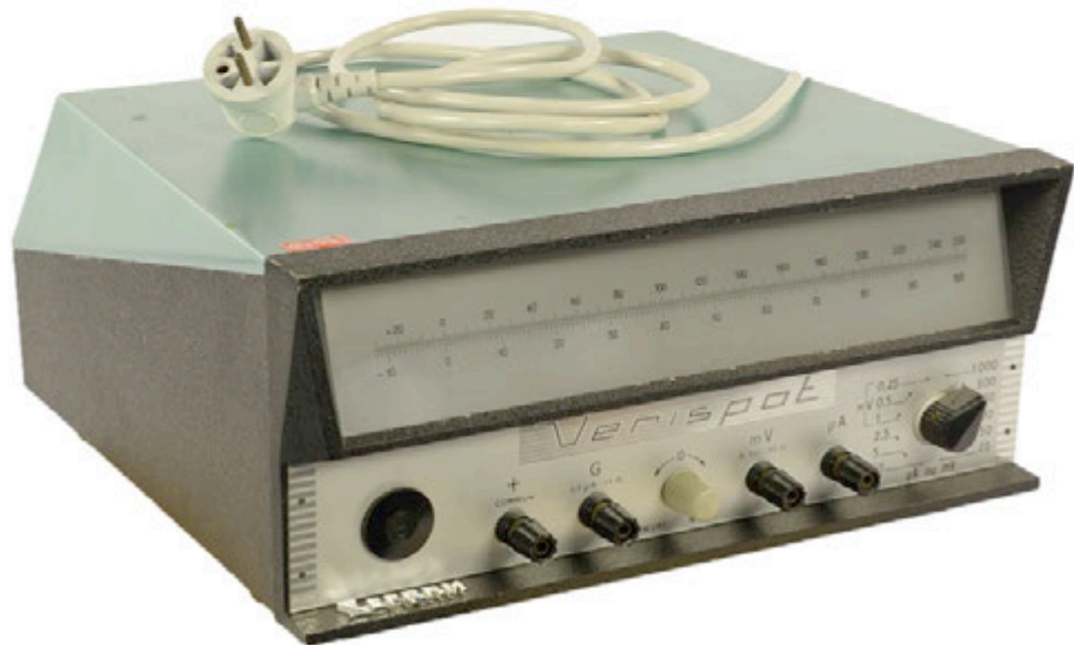
Millivoltmètre - galvanomètre à cadran mobile - Sefram - Verispot Verivat N°2794, T. Névo, 2013, © T. Névo.
