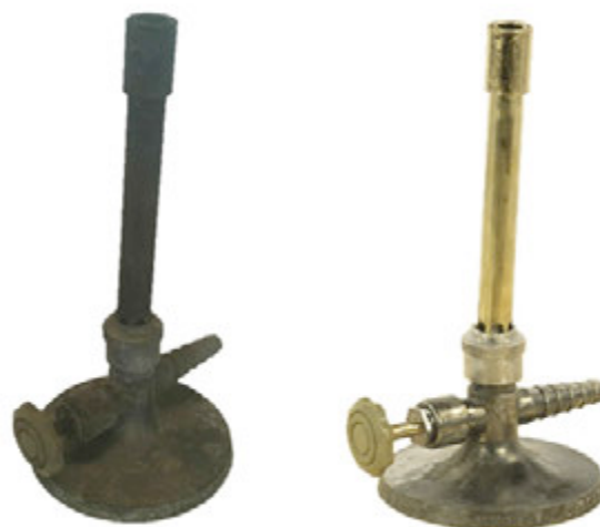
Fig. 3 Bec Bunsen - Prolabo avant et après polissage, © Thomas Névo.
