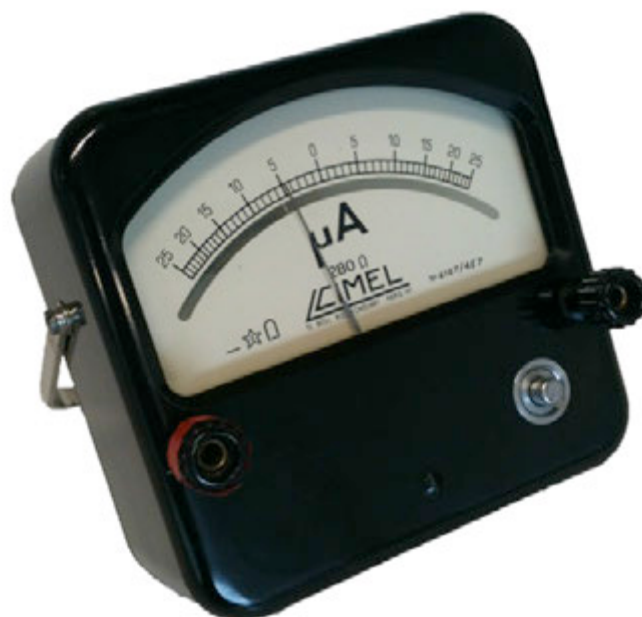
Microampèremètre - Cimel - B1382M, A. Poursuibes, 2013, photo retouchée par T. Névo, © A. Poursuibes.
