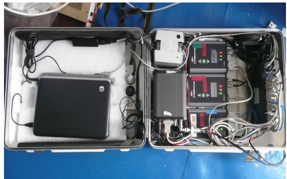
Illustration 28: Caisse étanche et dispositif d'acquisition des mesures (PC et récepteurs)
