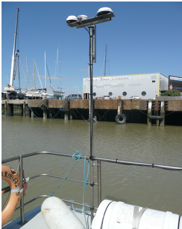
Illustration 32: Mât comprenant les trois antennes
