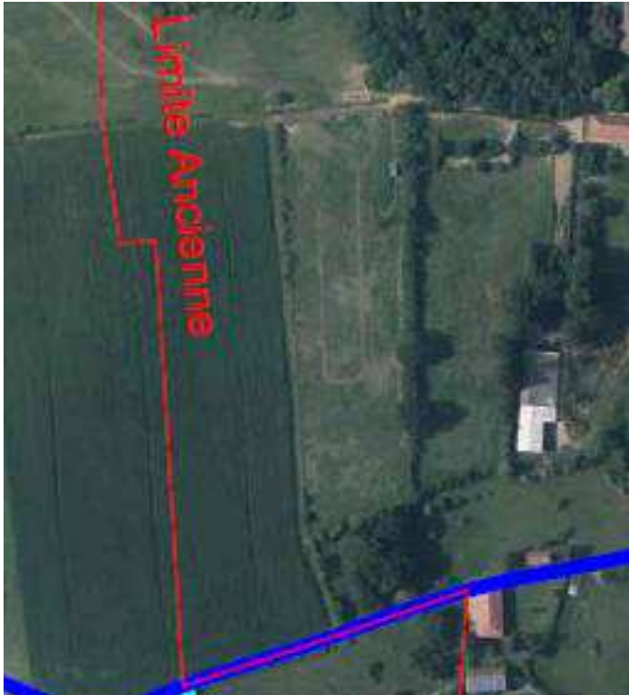
Figure 13 : Représentation de l'ancienne limite (en rouge) par rapport à l'ancien chemin (en bleu). Le passage de la limite d'un côté à l'autre du chemin et le passage du chemin d'une commune à l'autre nous porte à croire que la limite était positionnée à l'axe.
