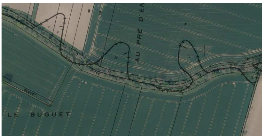
Figure 18: Exemple montrant la modification du lit d'un cours d'eau par rapport à une limite communale. (Limite Tarn - Haute-Garonne). Cet exemple sert uniquement de principe visuel.
